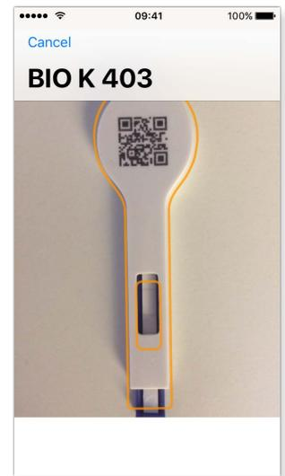
■ L'application détecte automatiquement le dispositif SmartStrips™ et capture la zone de test.
